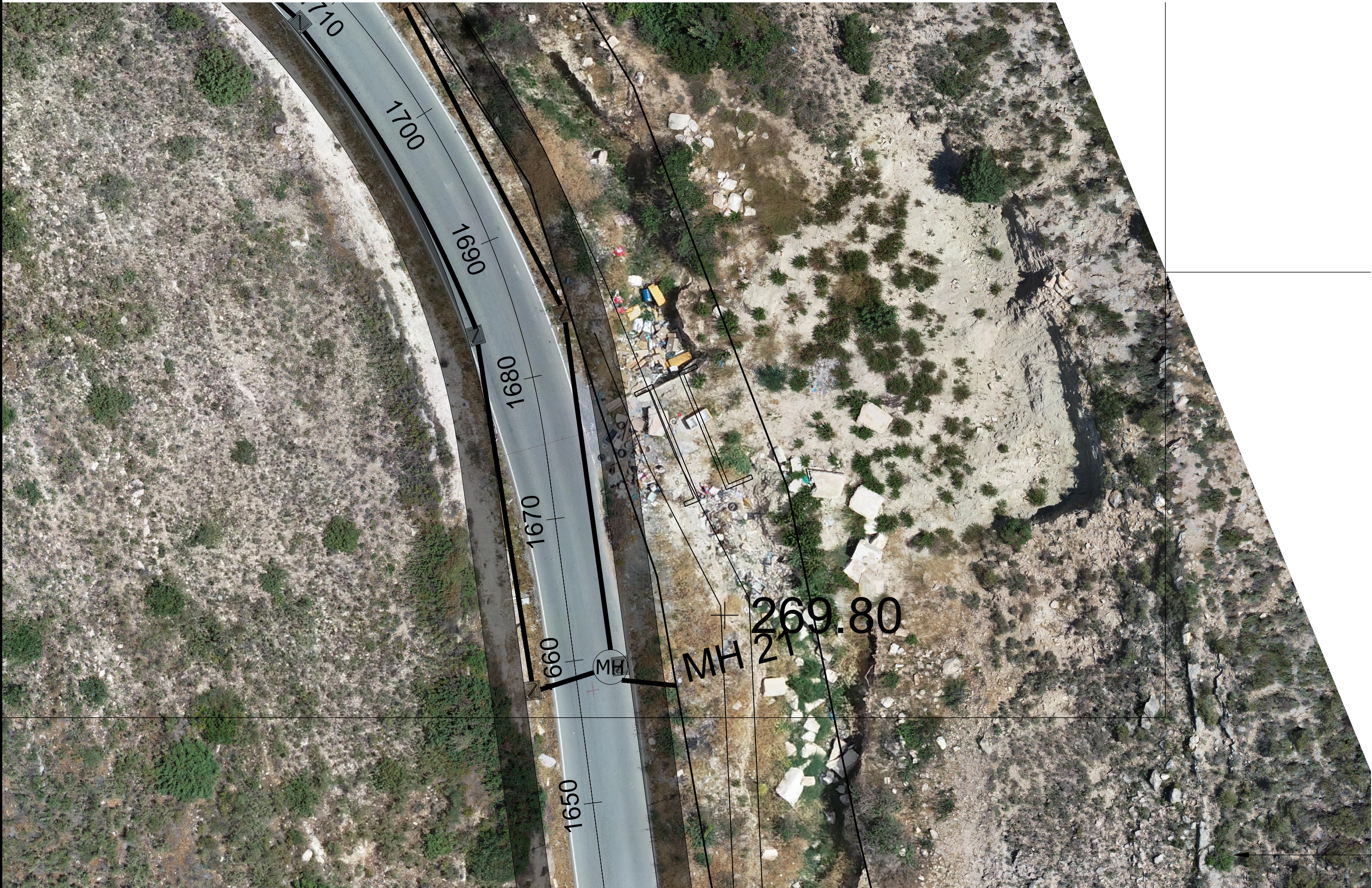
ΟΡΘΟΓΩΝΙΚΟΣ ΟΧΕΤΟΣ ΧΘ: 1+670 ΚΑΤΟΨΗ ΚΛΙΜΑΚΑ: 1:250
